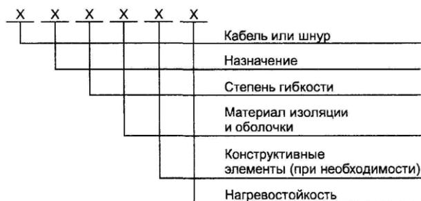
Примечания 1 При выполнении изоляции и оболочки из однородных материалов (кроме резины) обозначение материалов указывают один раз.
